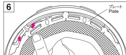
図のようにプレート近くを持ち片方ずつプレートを引きぬきます。
