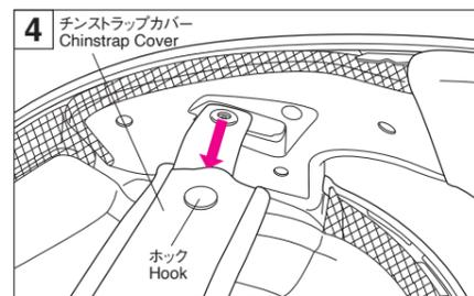
チークパッドを取りはずした後、チンストラップカバーのフックを1ヶ所はずし、チンストラップから引き抜いてください。
