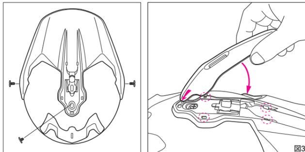
バイザー中央部のバイザーカバーを先端部より図1のように引き起こし取りはずします。左右及び中央のバイザースクリューを取り、バイザーを取りはずします。バイザー中央部裏面には、ゴム製のパーツ(図2)が装着されていますので、紛失しないよう注意してください。バイザー取り付けは、3カ所のバイザースクリュー(中央部に短いスクリューを使用)をしっかり取り付けた後、図3のようにバイザーカバー後端のフックを差し込み、他の4カ所のツメを確実に取り付けてください。ツメがはまりづらい場合は左右どちらか一方から取り付けるようにしてください。
