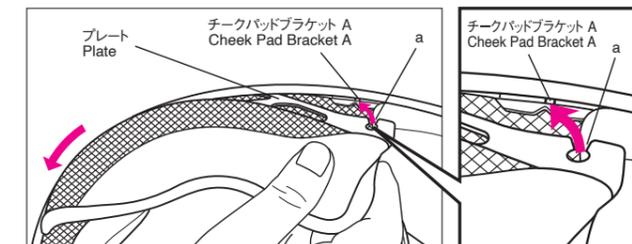
取りつける時は必ずはじめにチークパッドの左右を確認しチンストラップをチークパッドのくぼみに通した後、プレート後端部をチークパッドブラケットBにプレートのb部分をひっかけ、次に、チークパッドブラケットAにプレート前部のa部分が入るようにプレートを押しこんでください。
