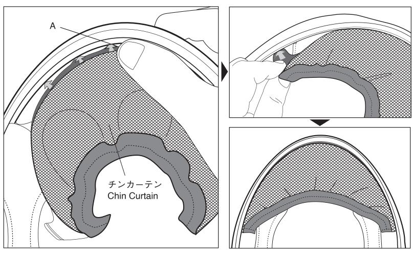
チンカーテンはヘルメッ トのアゴまわりの風の巻 き込みを防ぎます。取り つけはまずプレートの 中央とヘルメット先端部 中央を合わせ、シェルと ライナーのすき間(A)に 差し込んだ後、両サイド のプレートを差し込んで いきます。取りはずし は、チンカーテン中央部 分のプレートを先に引 き起こし抜き、両サイド を抜き取ります。
