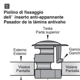
2 Spingere il gancio del perno con una piastra per inserire il perno nel foro più in profondità.
