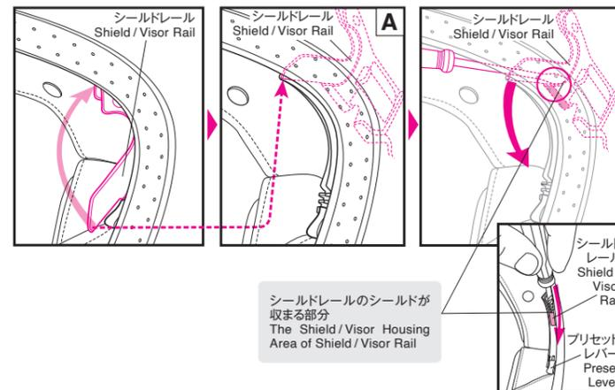
シールドレールのシールドが収まる部分 / The Shield / Visor Housing Area of Shield / Visor Rail
