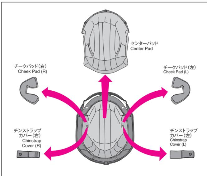
当製品はセンターパッド、チークパッド(左右)、チンストラップカバー(左右)を取り外して洗うことができます。また、オプションパッドと交換することで、かぶり心地を調整することができます。内装の名称と図を参照して、着脱を確実に行ってください。センターパッド、チークパッド、チンストラップカバーは、必ずすべて装着してご使用ください。内装を交換する場合は、下記表を参照のうえ、正しいサイズのものをお求めください。
