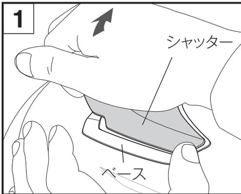
GT-Airアッパーエア インテークの取り外しは、図1のようにシャッターを全閉～全開の中間位置に合わせた状態で、シャッター前部の隙間に指を引っ掛け、上に引き抜きます。次に、ベースを固定しているビス(3か所)を取った後(図2)、シェルの表面のゴミ、ホコリ、油分を取り除いてください。
