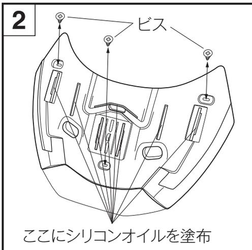
取り付けは、ベースのビス穴と吸気口をシェル側の穴と合わせ、付属のビスで3か所を固定してください。次に、ベースのレールと溝の部分(図2参照)およびシャッターの爪に、少量のシリコンオイル\*を塗り、シャッターの爪をベースの溝の広がっている箇所に重ね合わせ(図3参照)、図4の点線部分を①→③の順にカチッと音がするまで押しはめ込みます。取り付け後、シャッターがスムーズに開閉するか確認してください。
