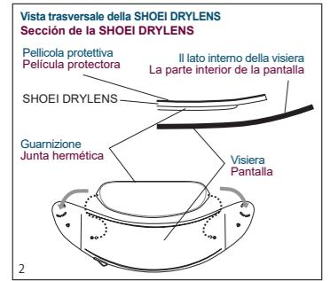
2-1 Instale SHOEI DRYLENS de forma que los sellos de la junta hermética entre la lente y la visera se encuentren como se indica en la ilustración 2. Antes de realizar la instalación, despegue aproximadamente 2 centímetros de la película protectora tanto del lado derecho como del izquierdo de la SHOEI DRYLENS. Limpie la parte interior de la visera antes de instalar la SHOEI DRYLENS. No toque la SHOEI DRYLENS en la parte de la junta hermética.
